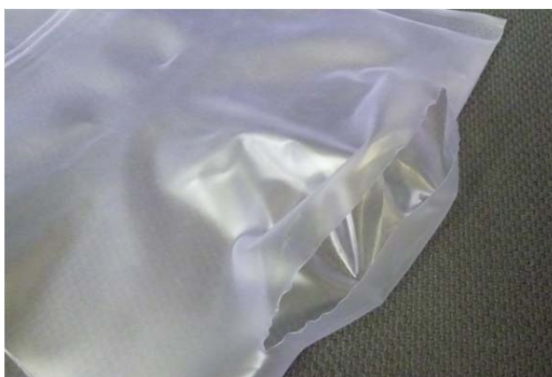
図 7.1.2-6 破裂状態の例 No. 10 (直線)
