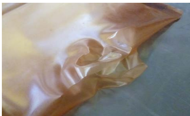
図⑭-7 蓋なし試験 破裂後の樹脂製の袋の写真
