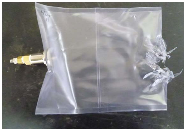
図 7.1.2-5 破裂状態の例 No. 9 (放射状)
