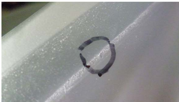
図 7.1.2-7 破裂状態の例 No. 11 (穴)
