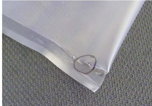
図 7.1.2-10 樹脂製の袋の膨張の様子と破損状態 No. 4 (穴)
