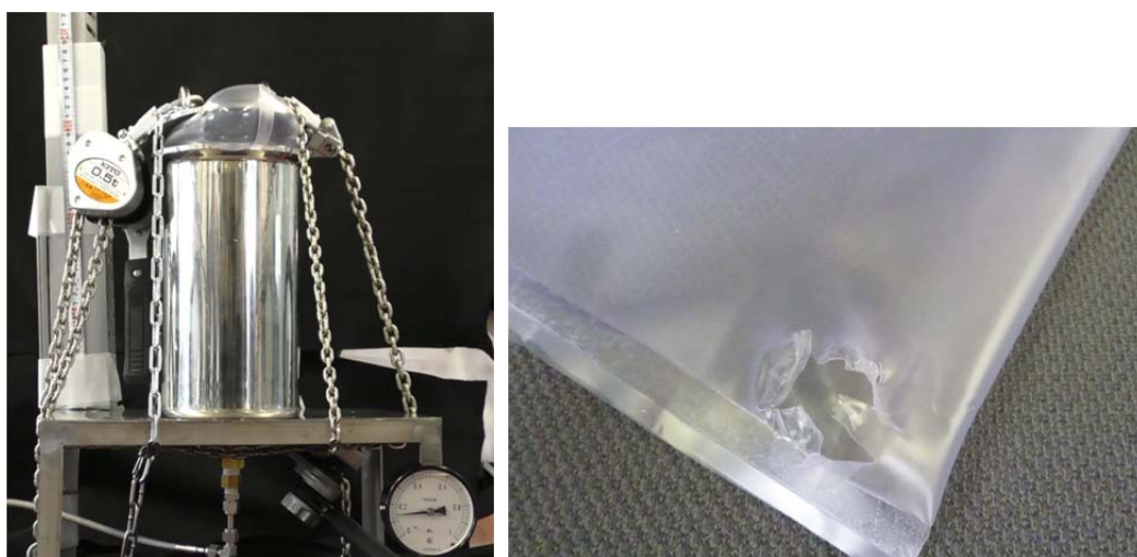
図 7.1.2-9 樹脂製の袋の膨張の様子と破損状態 No. 3 (放射状)
