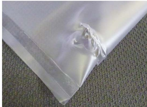
図 7.1.2-11 樹脂製の袋の膨張の様子と破損状態 No. 5 (直線)
